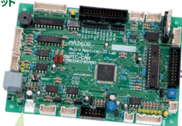
MA260はdsPIC30F組込用CPUユニットです。CAN通信をメインに様々なI/Oユニットを利用し、計測器、制御器を構成できます。CPUにはDSP機能を持つdsPIC30F6014を搭載、120MHz最大クロックで動作します。CANは2系統のインターフェース装備し2つの独立したLANを制御できます。計測用途を意識し12bit A/D・D/Aといったアナログ系の機能を充実させています。拡張I/Oは全22ポートを自由に利用できます。サブCPUとしてPIC16,18の28ピンデバイスを搭載できます。グラフィックLCDや文字LCD接続をオプションとして用意していますが、ユーザが独自のインターフェースを構築し、メインCPUの負担を軽減するといった利用も可能です。RTCリアルタイムクロックを搭載。入力デバイスとしてロータリエンコーダやPS2フルキーボードを接続可能。
